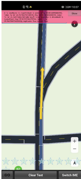
图 2. 停止线问题（停止线位于路口面内）
