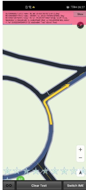
图 1. 中心线存在问题的图片（中心线长出路口）
