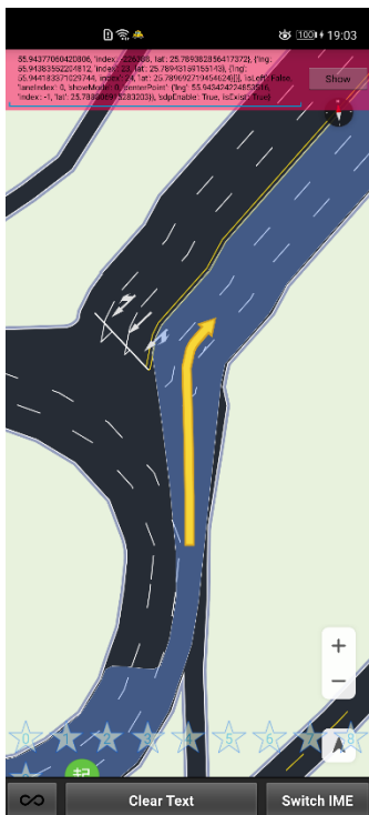
图 6. 箭头问题（车信箭头布局有压盖）
